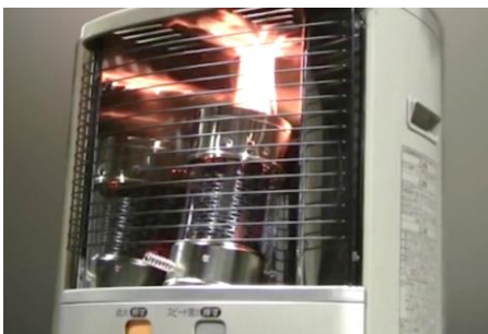
燃烧筒のずれによる異常燃烧
